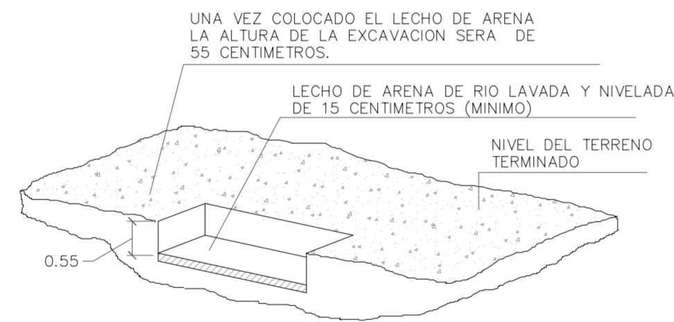
DIMENSIONES MINIMAS DE EXCAVACION 3,50x7,00m
