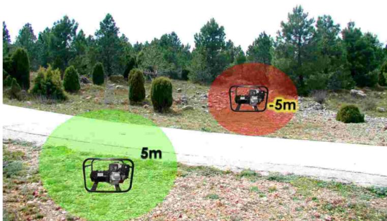
2. La carga de combustible de motosierras, motodesbrozadoras o cualquier otro tipo de maquinaria se realizará sobre terrenos desprovistos de vegetación, evitando derrames en el llenado de los depósitos y no se arrancarán, en el caso de motosierras y motodesbrozadoras, en el lugar en el que se han repostado. Asimismo, únicamente se depositarán las motosierras o motodesbrozadoras en caliente, en lugares desprovistos de vegetación.
