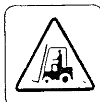
SA-370 PELIGRO PASO DE CARRETTILLAS
